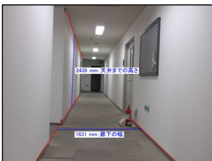
平行線間距離計測モードイメージ
