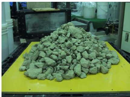
写真-4 発破ずりを模擬した岩石ずり
