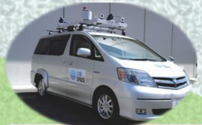
高精度GPSシステムと 3種類6台のカメラを搭載した車両
