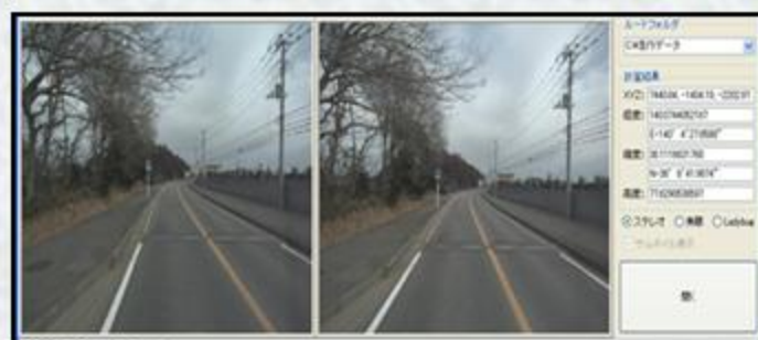
<道路地図用データ収集システム> 3次元精密位置計測システムの応用 +GPSとの併用
